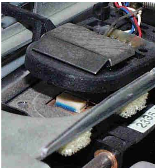
Schreib-Lesekopf eines 5"-Disk-Laufwerkes
