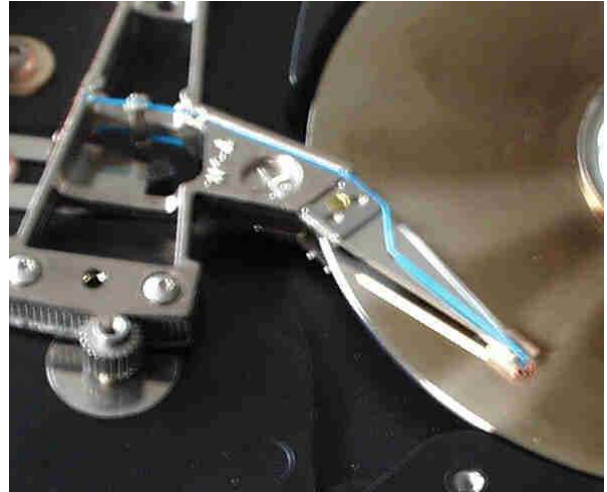
Aktuator und Kopf einer geöffneten Festplatte
